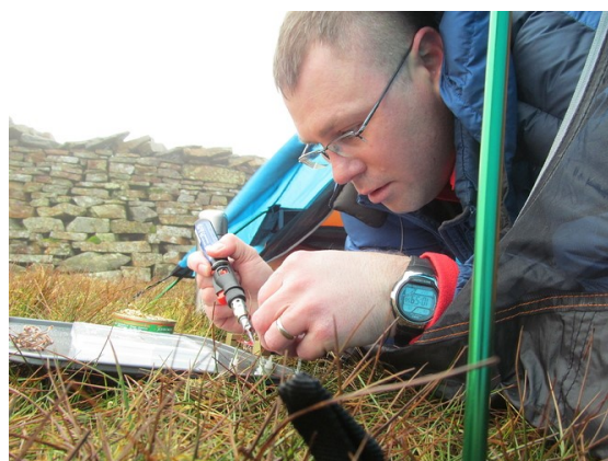
Colin – M1BUU soldando los componentes de su Rockmite en kit
